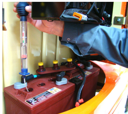
Obrázek 5-8. Měření specifické hmotnosti elektrolytu
