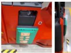
LTO nabíjecí přípojnice
