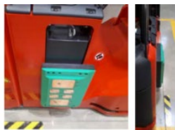
LTO nabíjecí přípojnice
